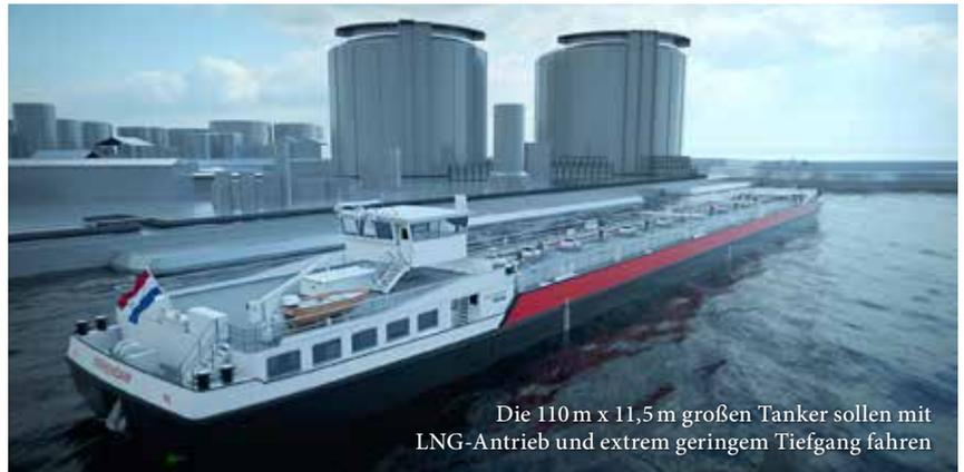
Die 110 m x 11,5 m großen Tanker sollen mit LNG-Antrieb und extrem geringem Tiefgang fahren
